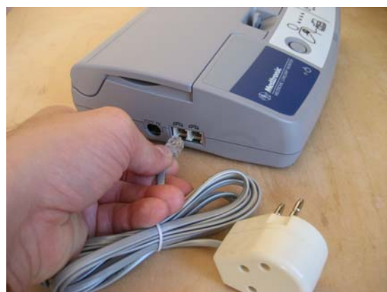
Aansluiten van het telefoonsnoer: de ene kant van het meegeleverde telefoonsnoer wordt in het linker gat gedaan, de andere kant wordt aangesloten op de huistelefoonaansluiting.
