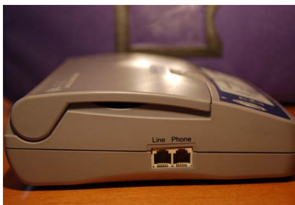
Aansluiten van het telefoonsnoer: de ene kant van het meegeleverde telefoonsnoer wordt in het linker gat gedaan, de andere kant wordt aangesloten op de huistelefoonaansluiting.
