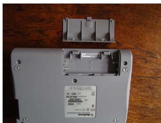
Plaatsen van de batterijen.
