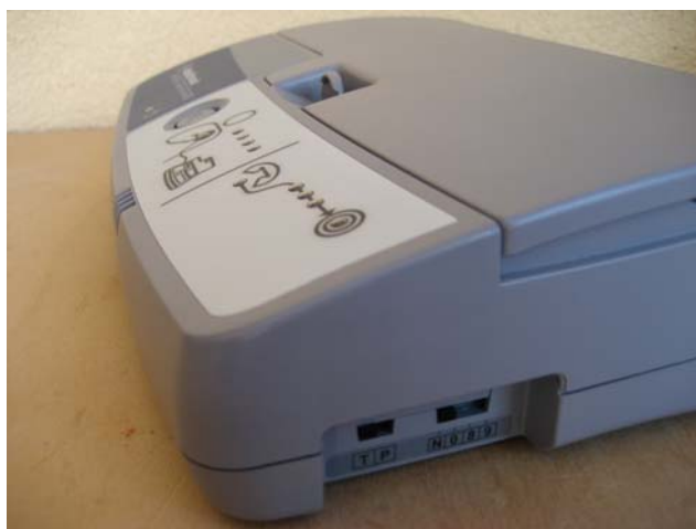
Schakelaars voor "T(one) of P(ulse)" en "N - 0 - 8 - 9" in geval van bellen naar een buitenlijn.
